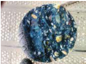
Dieser Betonkern wurde gewonnen, als man sich durch die Betondecke eines U-Bahn-Hofs an eine mit demselben Beton (Bunkerbeton C 50) vergossene KG- und PE-Leitung DN 100 heran arbeitete.
